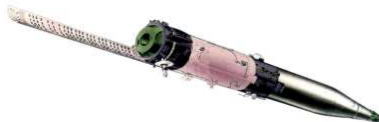
Космический аппарат «УС-А» с ядерным реактором
