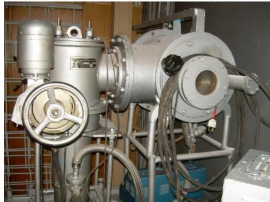
Вакуумная камера ВК-01  $\varnothing 0,3\text{м}$  в лаборатории кафедры СМ2 «Аэрокосмические системы»
